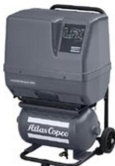
Power box montato su un serbatoio d'aria da 20 litri verniciato internamente con vernice epossidica (CE/AS1210 per 50 Hz, ASME per 60 Hz), comprendente la regolazione, valvola di sicurezza, regolatore di pressione, valvola di mandata, manometro e telaio carrellato. Per le unità trifase è compresa una protezione dal sovraccarico. Un'installazione di compressore oil-free completa, silenziata e mobile.
