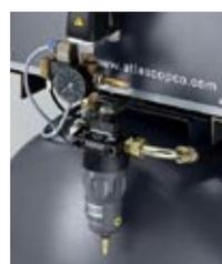
Proteggete i macchinari dei vostri impianti di produzione da olio, polvere e fango utilizzando i filtri. La combinazione di essiccatore e filtri riduce i tempi di fermo impianto e garantisce che l'aria compressa rimanga pulita e asciutta.
