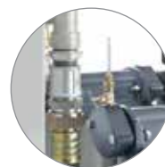
Indicatore di saturazione colonna VT (contenuto di olio)
