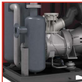
Scarico separatore d'acqua efficiente
